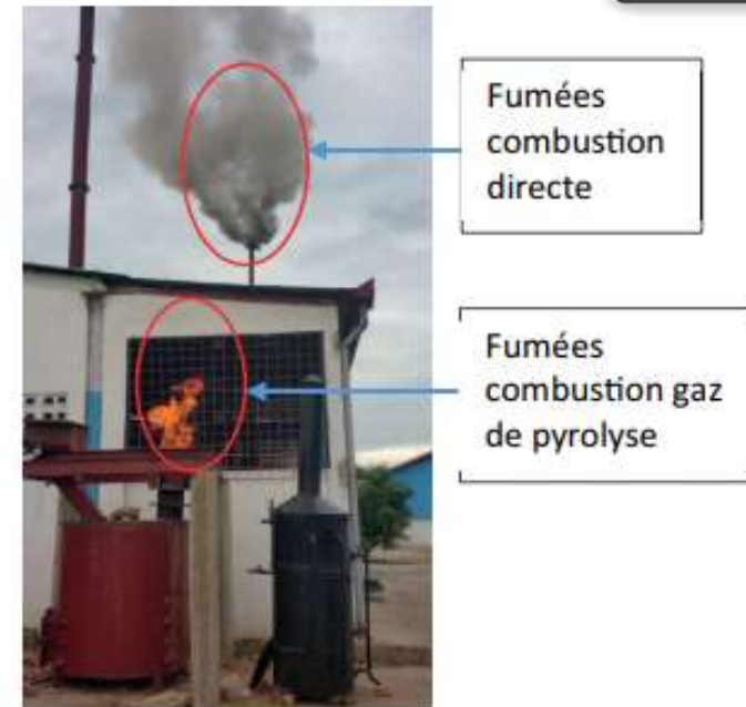
Figure 6 : Illustration de la qualité comparée des fumée de la flamme produite par le réacteur de pyrolyse et celles issue de la combustion directe des coques
